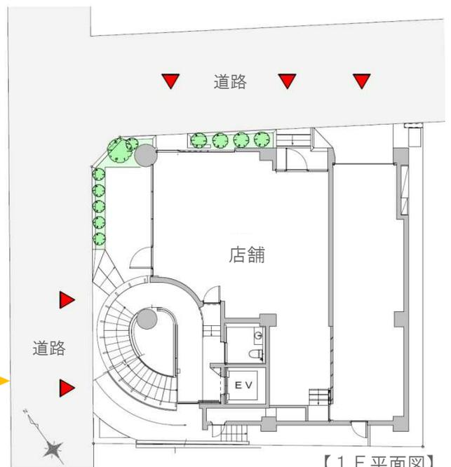
地下1階～地上2階までを店舗、3～4階を住宅としています。表参道の裏路地に建ち、テラスや植栽があり雰囲気があります。高低差のある敷地に二面道路。1階、地階店舗へのアクセスに工夫を凝らしました。遊び心ある螺旋階段は建物のアクセントにもなっています。
