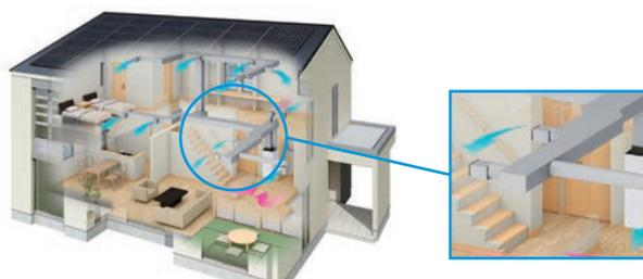
全館空調システム「エアロテック」の空調効率を最大限に高めるためグラスウールの成形ダクトの採用や、設計士による住まい方に応じたダクトワークにより、高い省エネ性の実現と体にやさしい快適空間を可能にします。
