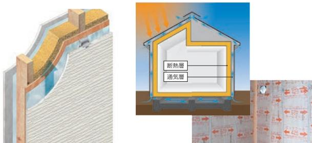
外壁には独自技術の「ハイサーキュレートシステム」を採用。通気層と断熱層のダブルガードで寒冷地エリアと同等の断熱性能を実現するとともに、壁体内結露を抑える優れた外壁仕様です。
